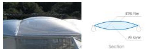
그림 3. ETFE 에어쿠션 구조
