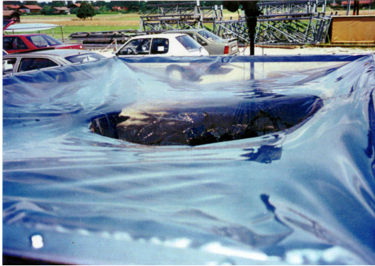
그림 8. ETFE 방화실험 사진
